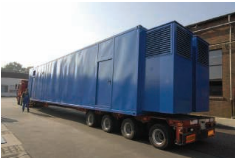
Рис. 18.14 Транспортировка контейнера на низкорамном прицепе
