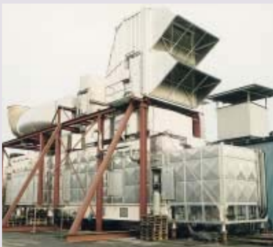
Испытания под нагрузкой на заводе Финспонг одного из двух энергоблоков SGT-600 для морской платформы на месторождении South Arne (Дания)
